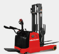
MFA15/20 额定载荷1500-2000kg 起升高度 5500 mm
