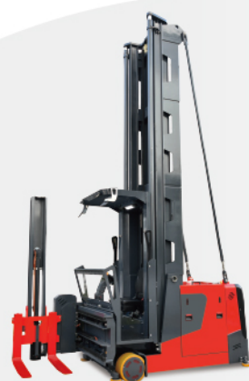
MCC16 额定载荷 1600kg 起升高度 10200 mm
