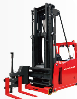
MCA15 额定载荷1500kg 起升高度 10000 mm
