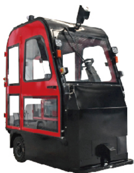
MGA60 额定载重:6T 牵引力:1200N 电池:48V280AH
